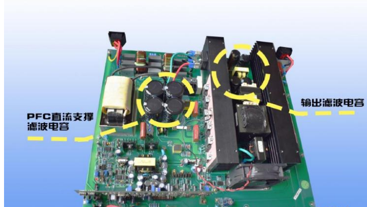
图 26: 新能源汽车充电桩中的铝电解电容
