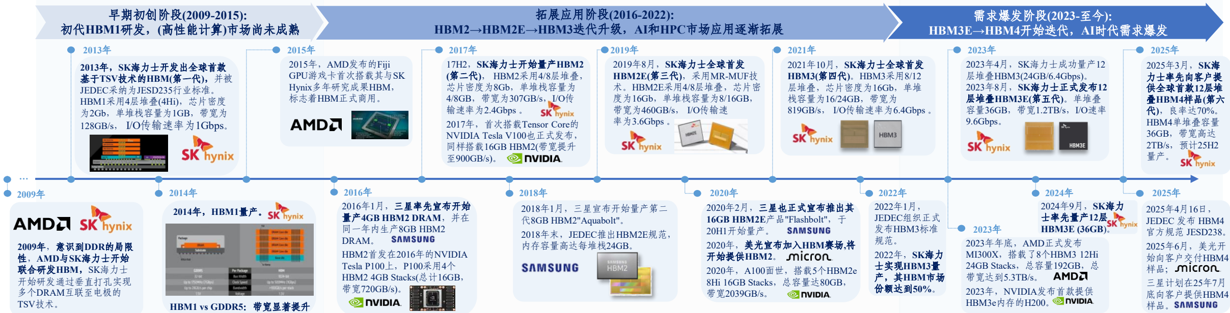
图：HBM发展历程：从HBM1到HBM3E不断迭代，迭代方向是提高容量和带宽，容量可以通过堆叠层数或增加单层容量获得提升，带宽提升主要是通过提升I/O速度实现
