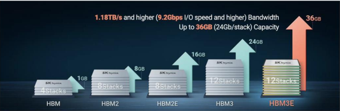
图：从HBM迭代到HBM3E：堆叠层数增至12层，单颗容量已增至36GB，HBM带宽持续提升
