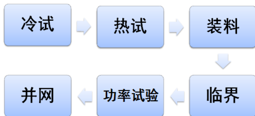
图 3：核电安装完毕后进入商运前流程
