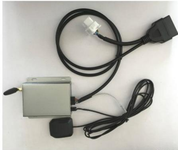
图 5: T-BOX 将连接 CAN 总线实现数据的收集
